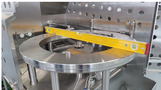
Hosszú vízszintező helyzete a továbbító szalag hosszanti irányába:
