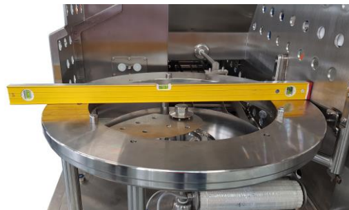
Hosszú vízszintező helyzete a továbbító szalag kereszt irányába:
